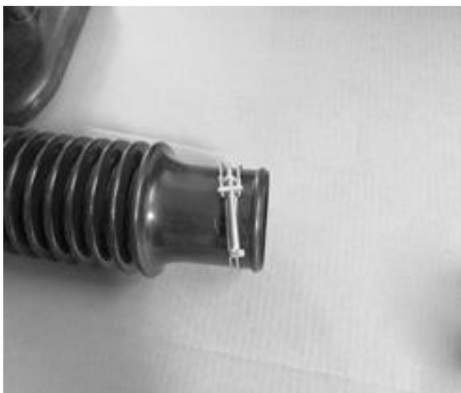
Encaixe o tubo sanfonado já com a braçadeira no encaixe da saída de ar do equipamento e em seguida aperte a braçadeira.
