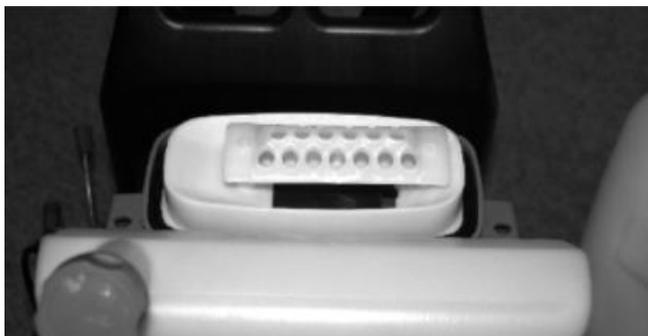
Recolocar o tanque químico no corpo do equipamento e apertar as porcas de fixação. Remover a mangueira para químico líquido juntamente com a ponta do tubo de ventilação. Fechar a saída de líquido do tanque com a tampa pequena que acompanha o equipamento.
