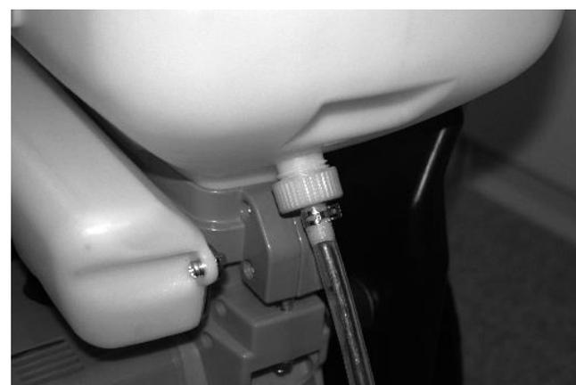
Recolocar o tanque químico no corpo do equipamento e apertar as porcas de fixação, conectar a mangueira para produtos químicos, rosqueando a tampa e conectando a ponta de borracha ao acessório para líquidos.
