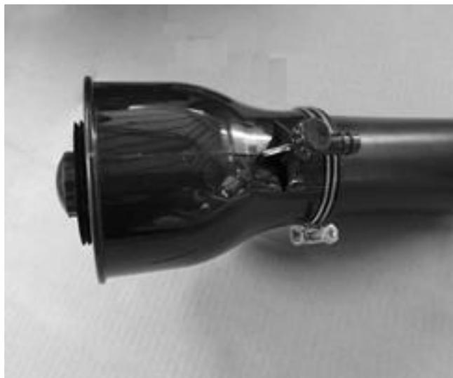
Fixe a torneira da mangueira de químicos na empunhadura. Em seguida, encaixe uma das mangueiras na saída do tanque químico e na entrada da torneira. E para finalizar, encaixe a outra mangueira na saída da torneira e no bico.
