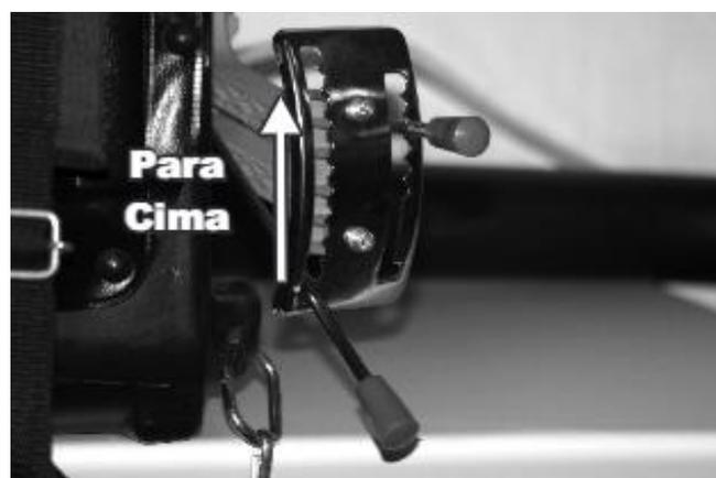
Se a vazão do pó não estiver atendendo as necessidades do trabalho ela poderá ser regulada reposicionando o tirante que movimenta a válvula de regulagem de vazão do pó, localizada entre o equipamento e o apoio para as costas.
