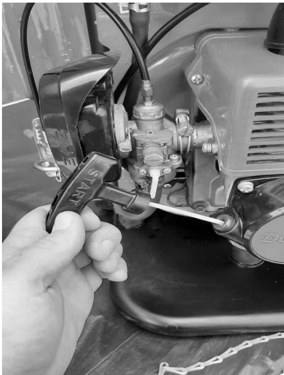
5. Após ligar a máquina abra o afogador lentamente. Deixe o motor aquecer de 1 a 2 minutos.
