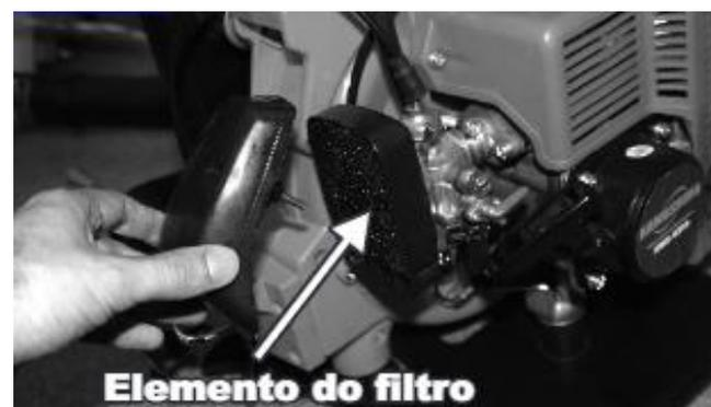
Diariamente após limpar o filtro de ar com detergente, embeba-o com óleo de motor e esprema-o firmemente com a mão para retirar o excesso do óleo.
