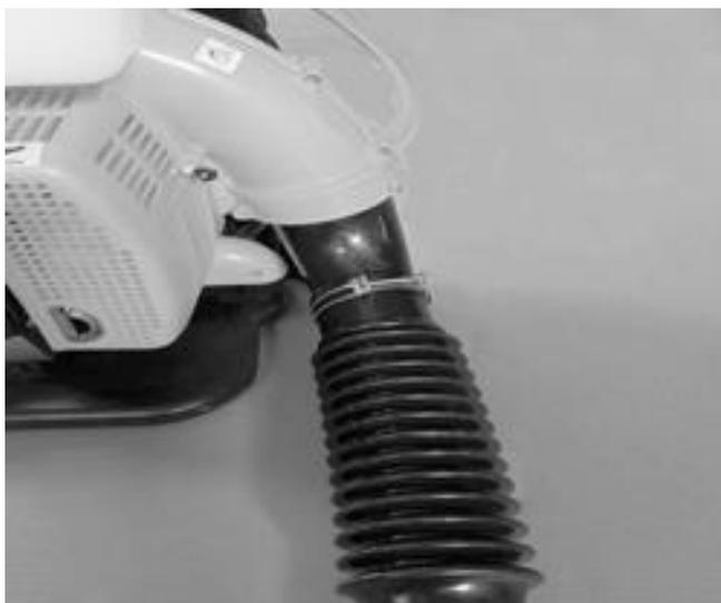
Encaixe a empunhadura no tubo reto. Coloque a segunda braçadeira na outra extremidade do tubo sanfonado e encaixe-o no tubo reto.
